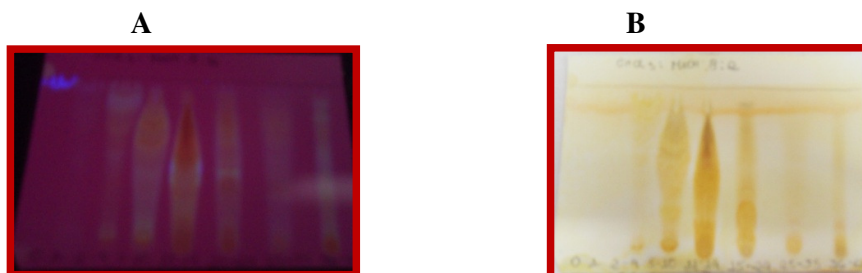
Figura 5: Frações obtidas a partir do fracionamento da fase clorofórmica 1. FM: \text{CHCl}_3 :MeOH; FE: sílica gel 60; Frações: 0; 1; 2-4; 5-10; 11-14; 15-24; 25-35; 36-62. Reveladores: A - luz UV 365 nm; B - reagente de Dragendorff.
