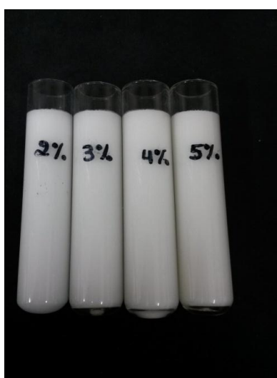
Figura 4: Centrifugação das 4 porções do creme Lanette
