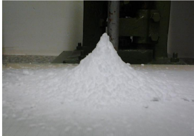
Figura 8: foto do cone obtido com o ibuprofeno para medir o ângulo de repouso
