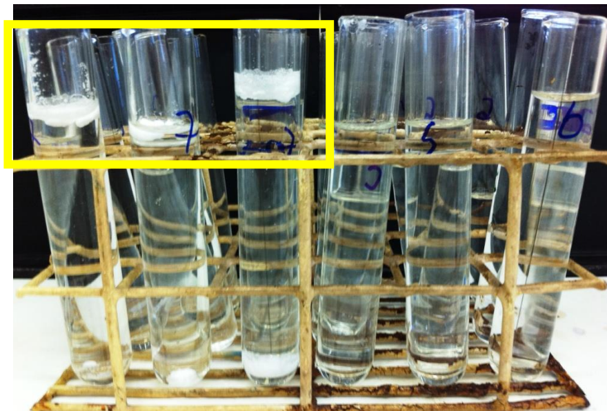
Figura 6: foto do teste de solubilidade com o ibuprofeno em diferentes solventes. Nota-se que o fármaco em água é praticamente insolúvel (quadro amarelo)
