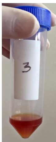
Figura 3 - Tubo facon contendo o enxaguatório de L.ferrea após teste de sedimentação.
