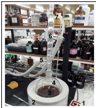
Figura 4. Sistema de extração estática exaustiva refrigerada por refluxo
