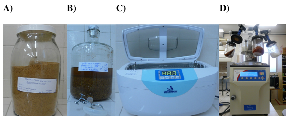
Figura 05 – Obtenção do extrato aquoso a 20 % por maceração. (A) Matéria - prima pulverizada; (B) Material sob maceração em frasco de Mariote; (C) Aparelho de ultrassom; (D) Extrato sendo liofilizado.
