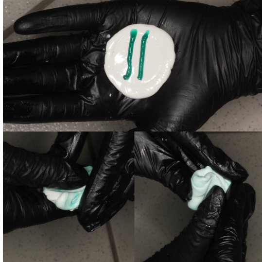
FIGURA 9: Manipulação do silicone de condensação (1 porção) + pasta catalisadora.
