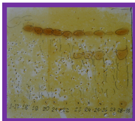
Figura 5: Análise das frações 1-33 oriundas do fracionamento da fase acetato de etila após reunião. (FE: sílica gel 60, revelador: reagente de Dragendorf)
